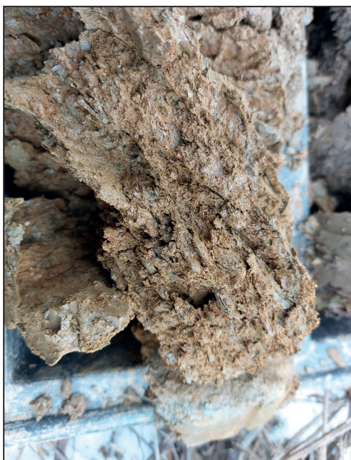
Detail silně zvětralého fylitu z vrtu S2
